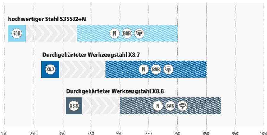
Eine hohe Grundhärte ist entscheidend für eine hohe Schlagfestigkeit und die lange Lebensdauer eines Schweisstisches. Durch die anschließende Plasmanitrierung und BAR-Beschichtung erfolgt eine Oberflächenveredelung, die das Material härtet und vor Kratzern, Korrosion und Schweisssperlenanhaftung schützt. Nur durch die Kombination aus hoher Grundhärte und Plasmanitrierung ergibt sich eine verschleissarme und langlebige Oberfläche.
